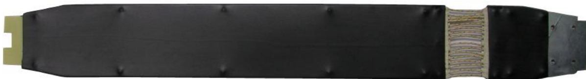
Рисунок 1.4.11. Вибратор антенного блока АБДЛ «Тритон»
