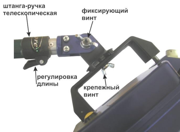
Рисунок 1.3.2. Крепление телескопической штанги-ручки к АБ-1700
