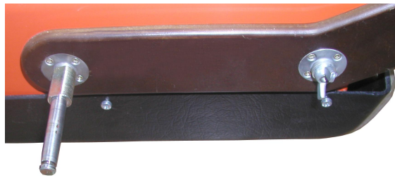
Рисунок 1.1.15. Установка осей на АБ-150 АБ-250
