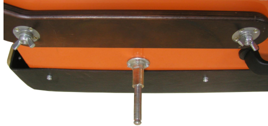
Рисунок 1.1.14. Установка осей на АБ-90
