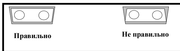
Рисунок 1.1.10. Подключение оптического интерфейсного кабеля
