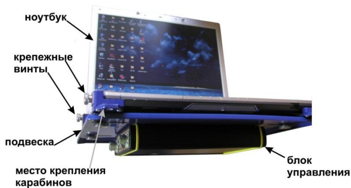
Рисунок 2.1.2. Подвеска с установленным ноутбуком
