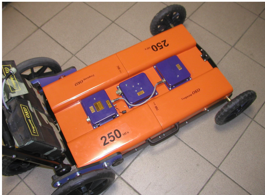
Рисунок 6.11 Антенный блок АБ-250+700 на двухколесной тележке с установленными дополнительными колесами малого диаметра.
