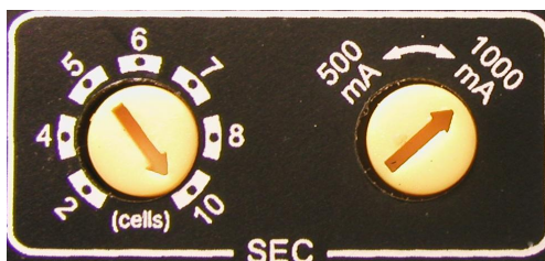
Рисунок 1.4.8. Положение тумблеров на зарядном устройстве
